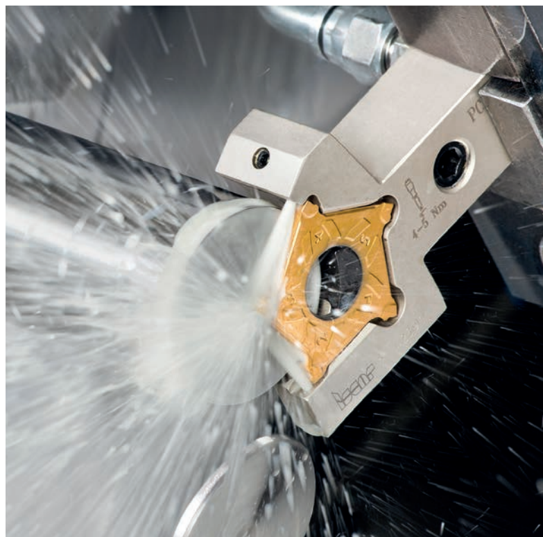
Bild 3 – PENTA-IQ-GRIP-verktyg med laxstjärtsformat skärläge tillför kylvätska i två riktningar under högt tryck.
