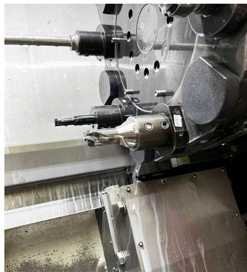
Die Pilotbohrung brachte ISCAR mit dem Wechselkopfböhrer aus der SUMOCHAM-Serie ein.
