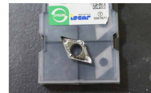
Die ISOTURN-WSP DCGT 11T304-AF IC20 ist für die Bearbeitung von Aluminium optimiert.
