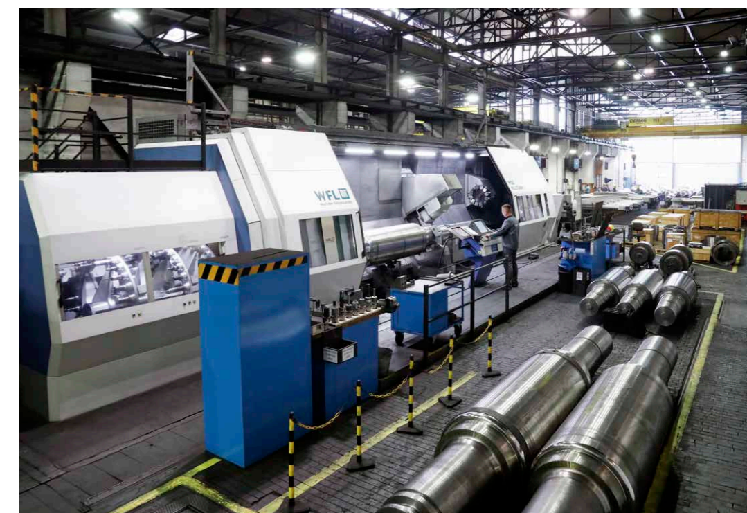
Zur wirtschaftlichen und exakten Komplettbearbeitung der Stahlwerkswalzen setzt ESW unter anderem auf Dreh-Frä Bohr-Komplettbearbeitungszentren von WFL.
