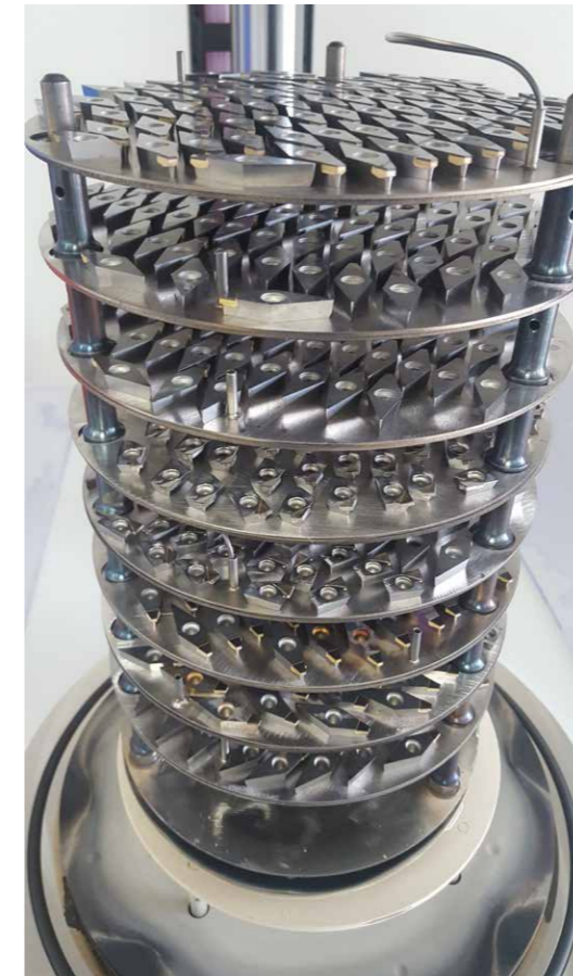
Die mit Lötpaste und Flussmittel versehenen Komponenten werden beim Hochvakuum-Löten prozesssicher verbunden.
