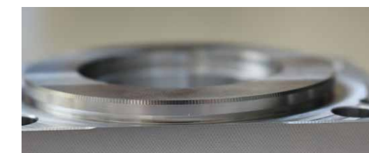
Der DIN-Außeneinstich am Gleitlagergehäuse nimmt später eine Dichtung auf.
