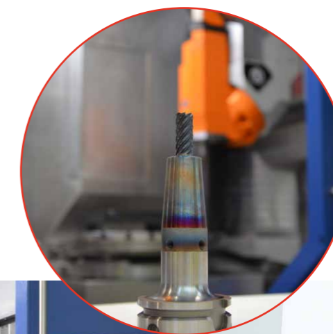
Mit dem VHM-Torusfräser von ISCAR erzielt der Hammer-Spezialist Halder eine um zwei Drittel kürzere Bearbeitungszeit beim Hartfräsen.
