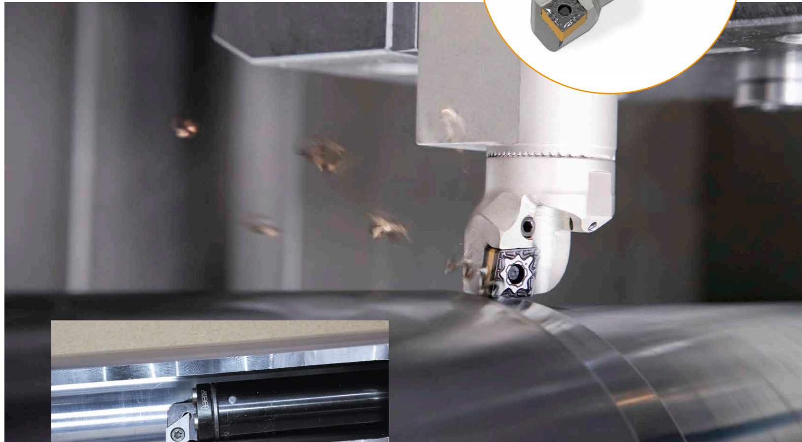
ISCAR hat seine NEOMODU-Reihe um zusätzliche Halter für das Plan- und Außendrehen erweitert. Die Standard-Vierkantschäfte gibt es in den Größen 20, 25, 32 und 40 Millimeter.
