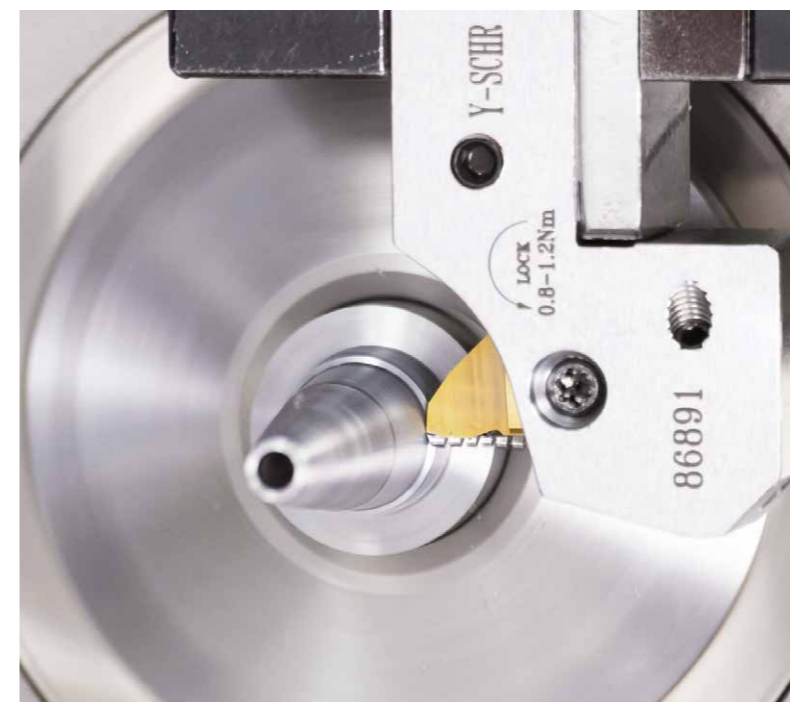
ISCARs NEOYSWISS-Werkzeuge erlauben das Drehen auf der Y-Achse.
