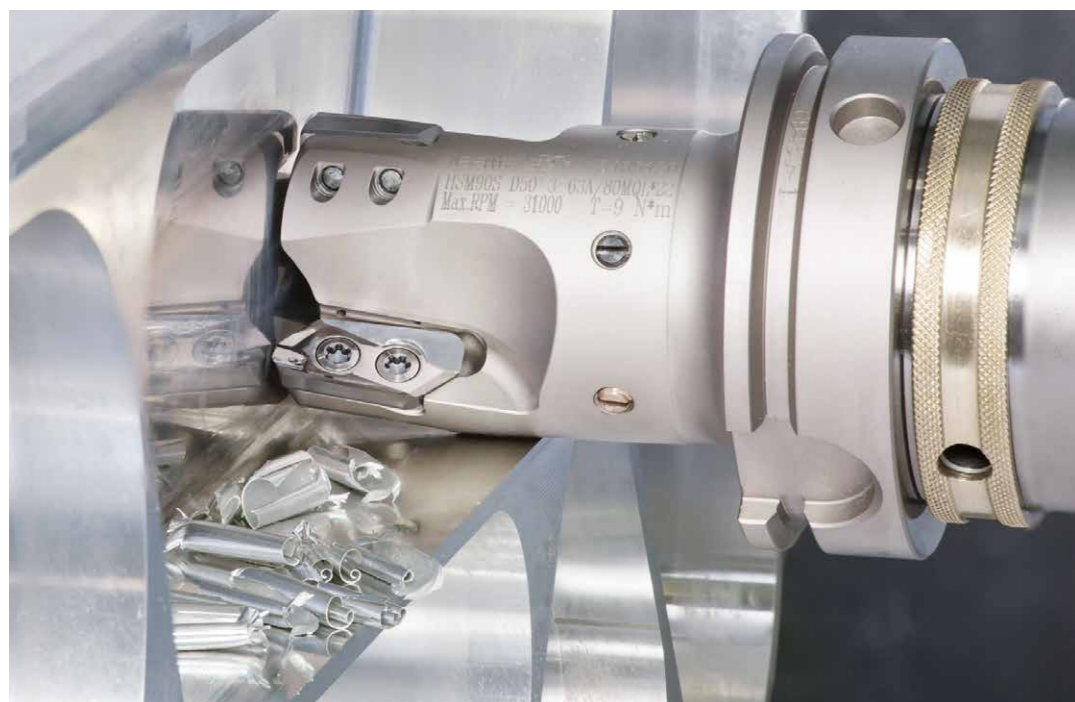
Die robuste Konstruktion von 90-Grad-Wendeschneidplatten-Fräsern ermöglicht das effiziente Bearbeiten von Flugzeugteilen aus Aluminium bei hohen Drehzahlen. Das erforderliche Anzugsdrehmoment für eine Wendeschneidplatten-Klemmschraube und die maximale Drehzahl sind wichtige Parameter.
