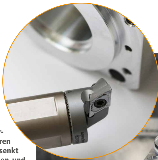
Für das Interpolationsdrehen bei Karl Walter Formen- und Kokillenbau kommt ein VHM-Schaft mit einem Durchmesser von 25 Millimetern, einer Auskraglänge von 7xD und DCGT-Adapterkopf zum Einsatz. Dieser ist bestückt mit einer DCGT 11T304-AF IC20 ISOTURN-Wendeschnidplatte.
