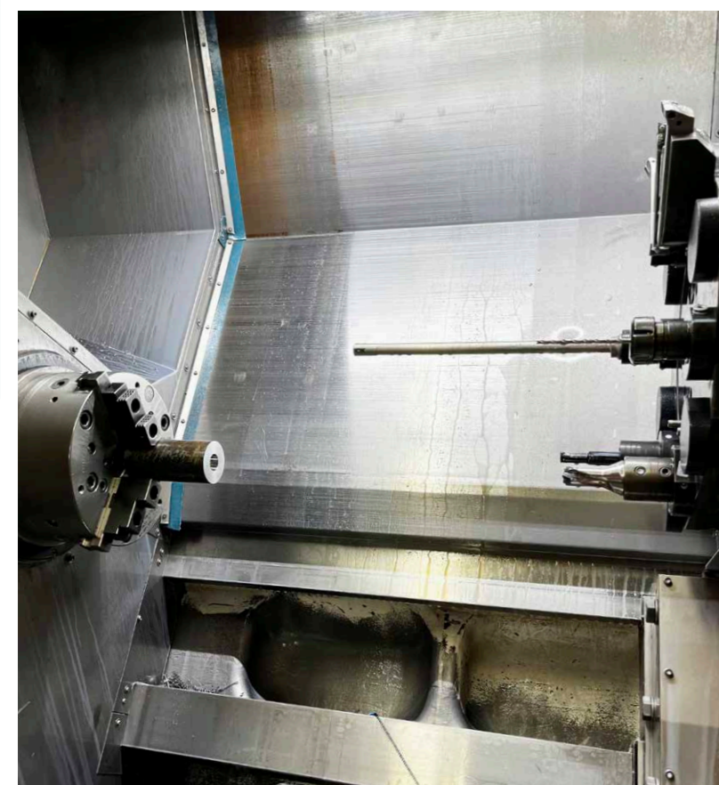
Bei einem neuen Bauteil, einer Zugstange aus Vergütungsstahl, musste ALMÜ eine 375 Millimeter tiefe Bohrung einbringen.
