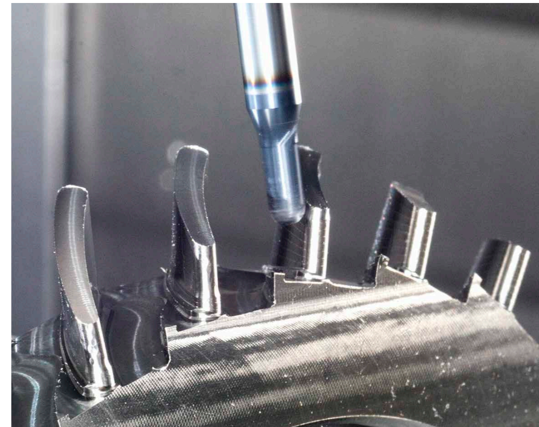
Für sehr gute Ergebnisse beim trochoidalen Fräsen eines Blisk-Schaufelblatts kann der mehrschneidigen VHM-Schaftfräser in einem Schrumpffutter gespannt werden.
