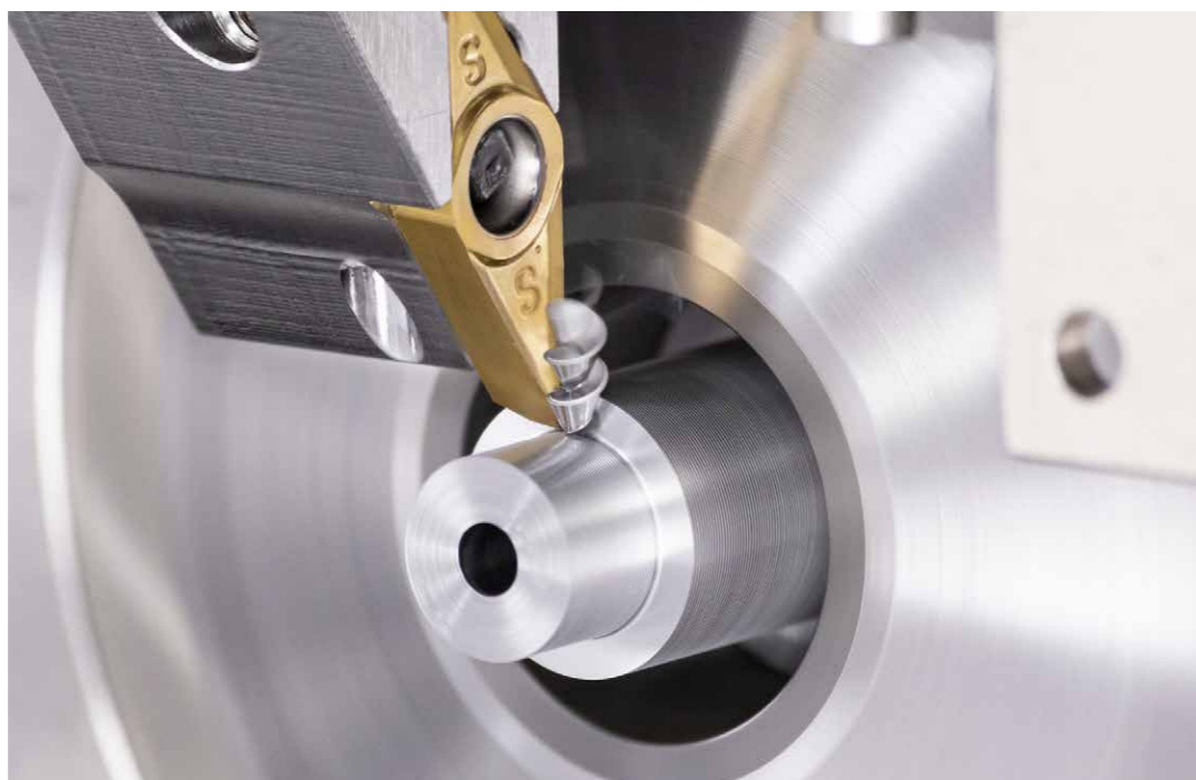
Speziell für das produktive Drehen von Kleinbauteilen hat ISCAR eine neue Generation an geschliffenen und polierten rhombischen ISO-Wendeschneidplatten im Programm.
