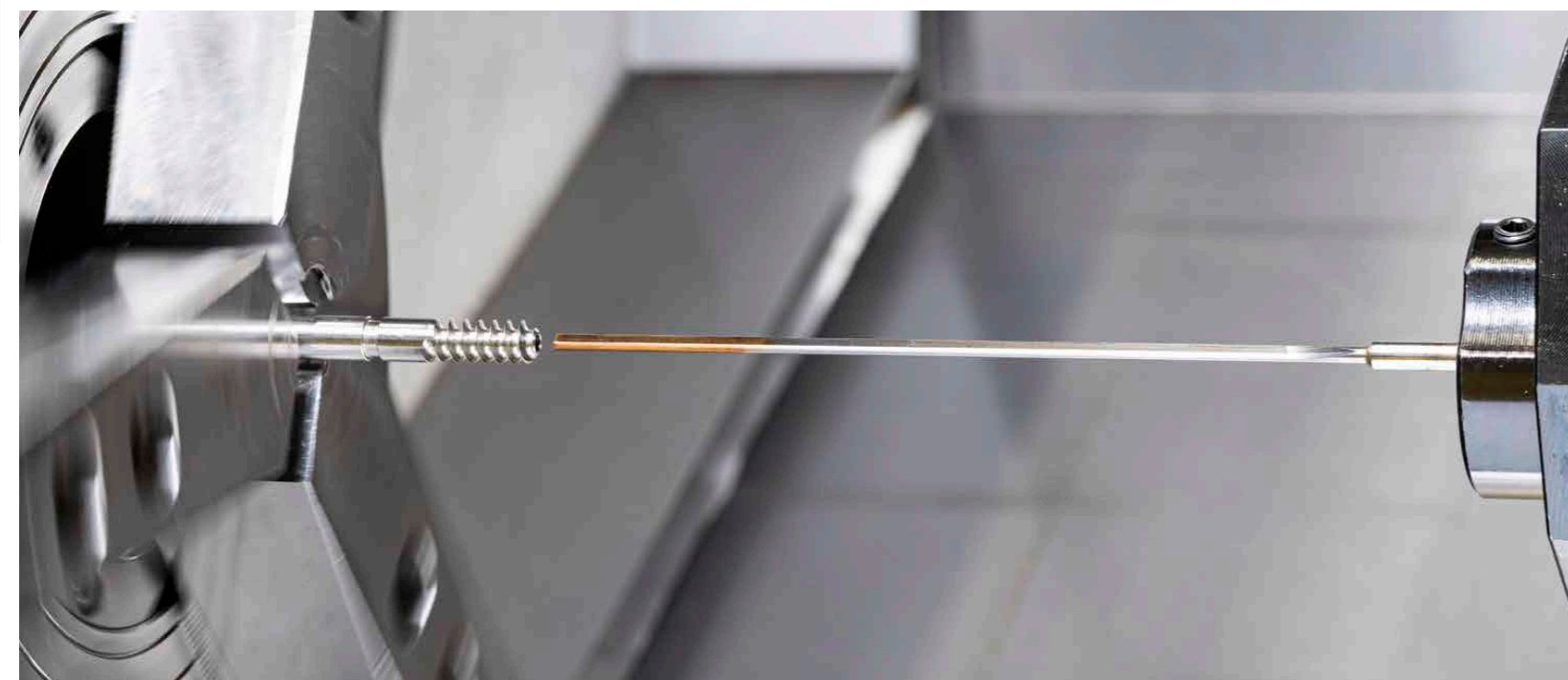
VHM-Einlippenbohrer kommen bevorzugt in der Massenproduktion zum Einsatz. Ihr VHM-Schaft verleiht ihnen eine hohe Steifigkeit.
