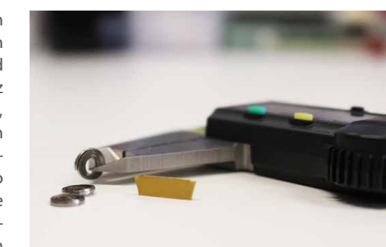
Der Spanformer garantiert einen weichen Schnitt und es entstehen schöne eingeschnürte Uhrfeder-Späne für eine optimale Spankontrolle.
