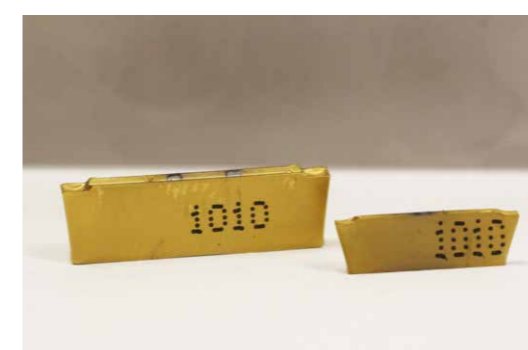
Die bislang eingesetzte Platte mit zwei Millimetern Schnittbreite (li.) und die neue Lösung im Vergleich.
