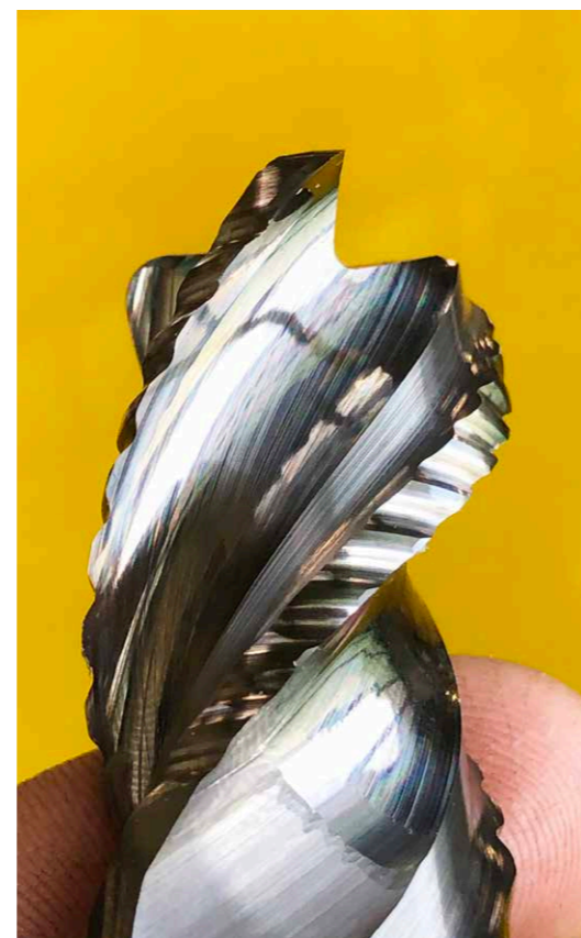
Bei den Werkzeugen konnte das Team aus dem Vollen schöpfen und das genau passende für die jeweilige Aufgabe wählen. Beispielsweise für die Aluminiumbearbeitung optimierte VHM-Fräser aus ISCARs MegaALU-Familie.
