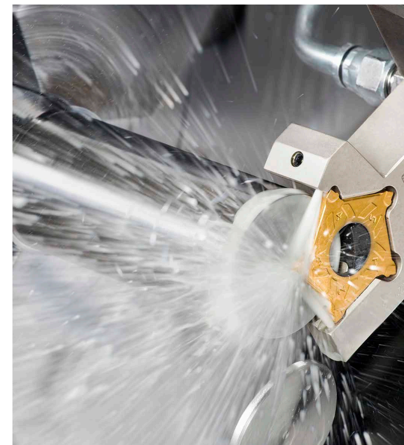
Das fünf-schneidige Abstechwerkzeug PENTA-IQ-GRIP ermöglicht das Abstechen von Werkstücken mit einem Durchmesser von bis zu 40 Millimetern.
