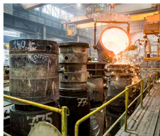
Das Eisenwerk Sulzau-Werfen (ESW) zählt zu den weltweit führenden Herstellern von Arbeitswalzen für die Stahlverformung. Gesichert wird die Qualität durch eine hohe Fertigungstiefe – von der eigenen Gießerei über die Wärmebehandlung bis hin zur mechanischen Bearbeitung.
