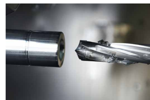
Durch den Einsatz des Wechselkopfböhrers LOGIQ3CHAM von ISCAR hat DEMMELER die Werkzeugkosten um 35 Prozent gesenkt.
