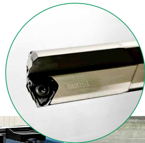
Bestückt ist der TRIDEEP-Bohrer mit einer Wendeschneidplatte aus der verschleißfesten TiAlN PVD-beschichteten Feinstkornsorte IC908, mit drei Schneidkanten, positivem Spanwinkel und spezieller Spanteilergometrie sowie einer Wiper-Breitschlichtfäse für hohe Oberflächengüten.
