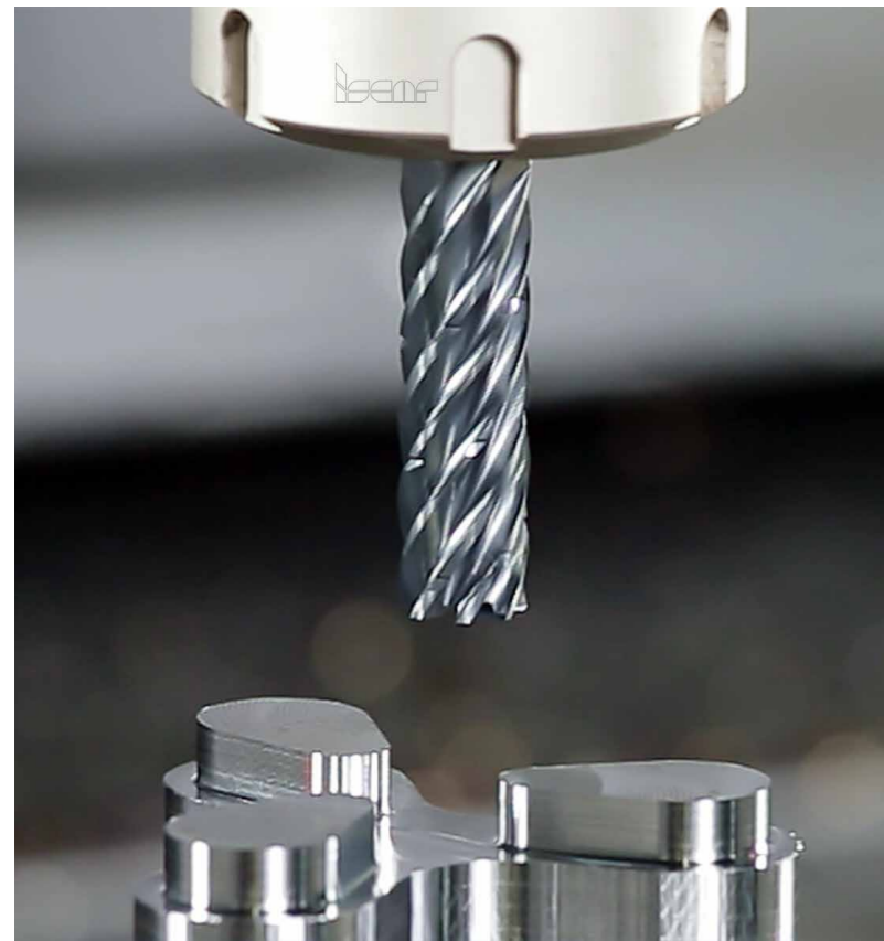
Eine Schneidkante mit Spanbrecher verbessert die Spanabfuhr und sorgt für eine sehr hohe Oberflächengüte.
