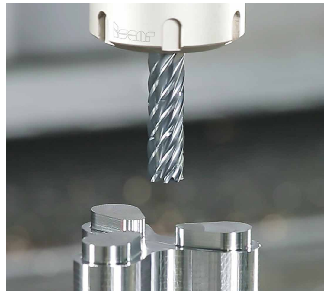
Der siebenschneidige Vollhartmetall-Schaftfräser von ISCAR für die HSM-Bearbeitung verfügt über unterschiedliche Spiralwinkel, ungleiche Teilung sowie Spanteiler an den Schneidkanten.
