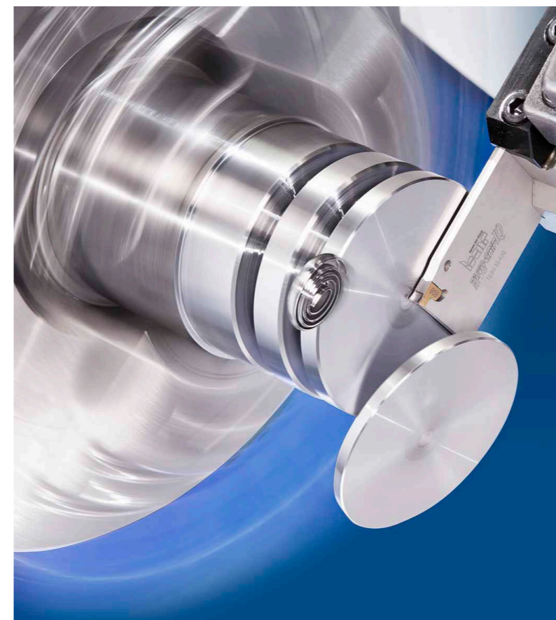
Dank der stabilen Klemmung kann der Schneideinsatz des TANG-GRIPs den auf das Werkzeug wirkenden Schnittkräften beim Abstechen entgegenwirken.
