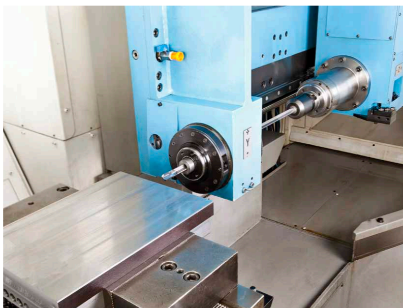
Die Werkzeuge werden meist auf speziellen Tieflochbohrmaschinen mit Bohrbuchsen eingesetzt. Der Vorteil: Eine Pilotbohrung ist nicht notwendig.
