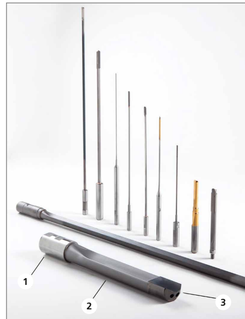
Während gelötete Einlippentieflochbohrer aus drei Komponenten bestehen – Einspannhülse [1], Profilirrohr aus Stahl [2] und Hartmetallbohrkopf [3] – werden beim Vollhartmetall-Einlippenbohrer nur zwei Komponenten verwendet, nämlich Einspannhülse [1] und VHM-Bohrerschaft [3].
