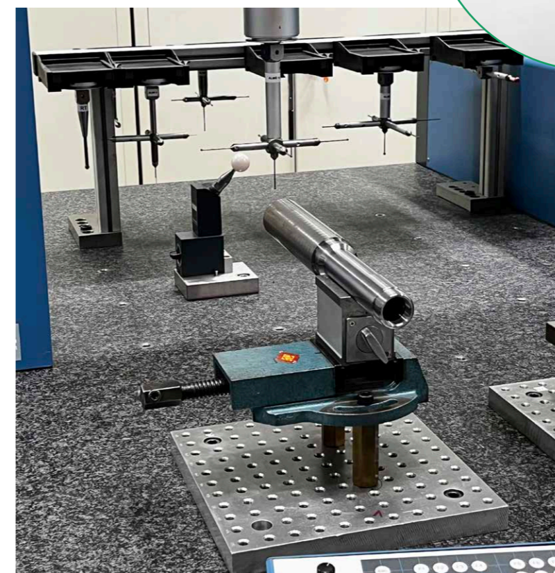
Die Messung auf Rundheit, Parallelität und Konzentrität der Bohrung zeigte ein durchweg positives Ergebnis: Auf der kompletten Bohrtiefe von 375 Millimetern ist die Bohrungsachse nur um 4,3 Mikrometer verlaufen, die Rundheit weicht nur um 27 Mikrometer ab, die Konzentrität liegt bei 87 Mikrometern.
