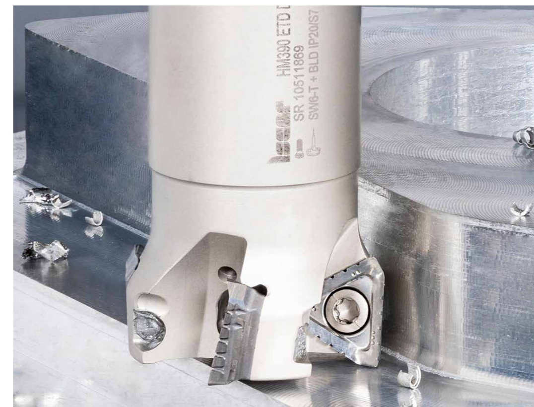
Die gezahnte Schneidkante der HELI3MILL-WSP ist für das Hochleistungsfräsen von NE-Werkstoffen konzipiert.
